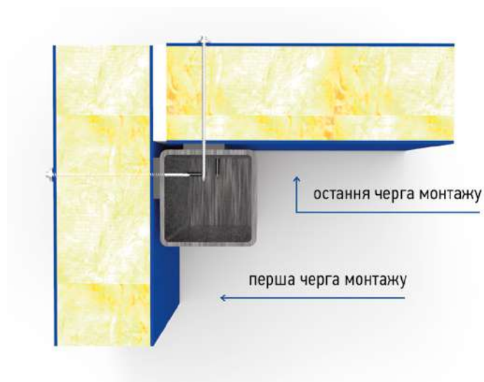
Мал. 10. Порядок монтажу панелей кутових
